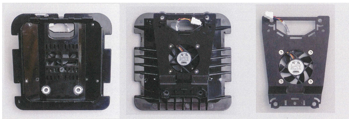
图 4.16: 前机架 注塑的前机架面板镶嵌了铝合金板，上面安有用于冷却腿的电机部分的风扇。风扇额定功率约1 W。(照片:加藤康)
