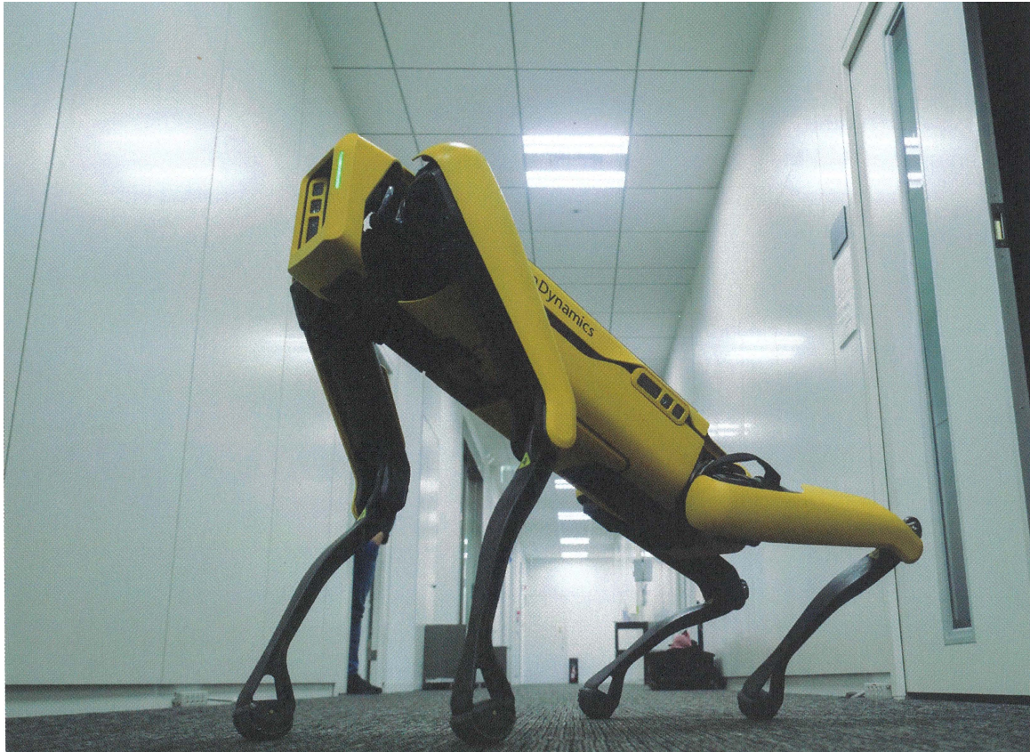
图 1.1: Spot的外观 它由波士顿动力公司开发和销售。外观看起来像狗一样，用四只脚走路。也可以上下楼梯。(照片:加藤康)
