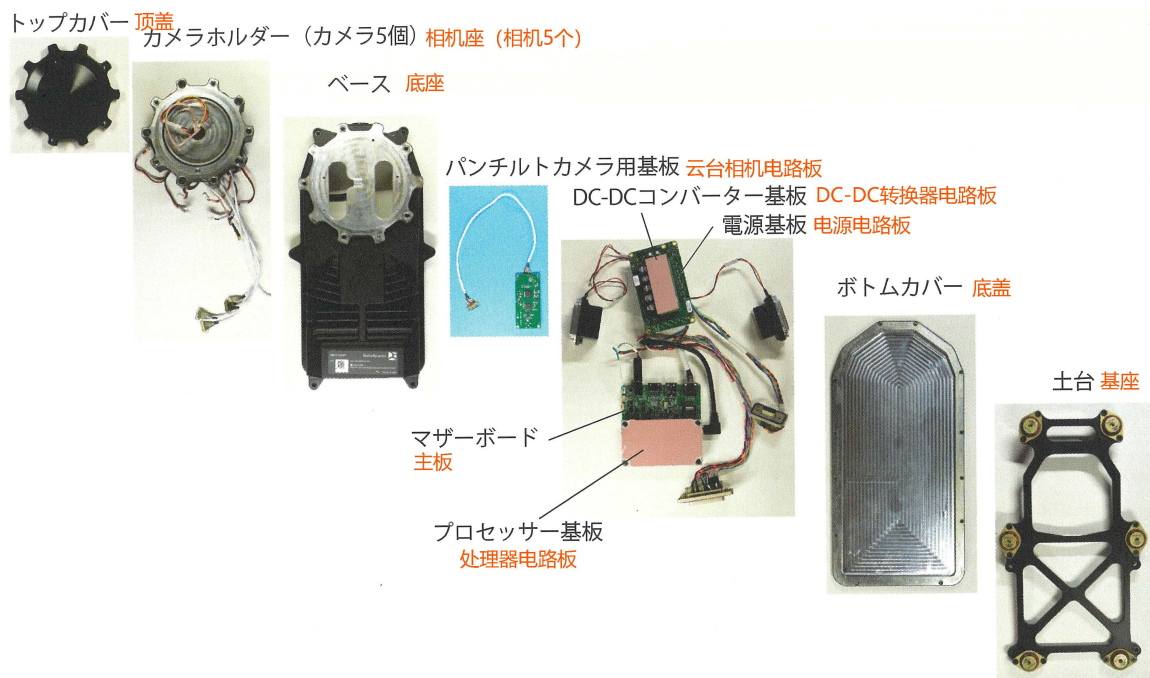
图 7.3: 拆解Spot Cam 相机电路板在相机支架中, 在这张照片中没有显示。除此之外, 它由5个电路组成。顶盖下方是云台变焦相机的接口。连接云台变焦相机时, 似乎是卸下了顶盖连接的。(照片: Fomalhaut Techno Solutions)
