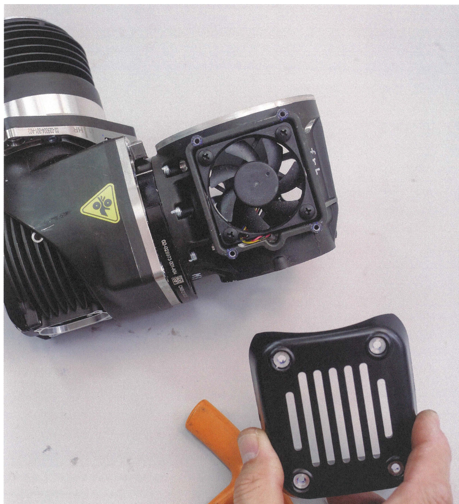
图 6.24: 膝关节驱动冷却风扇 冷却空气直接吹到Knee的线性驱动电机外壳的散热片上。(照片:加藤 康)
