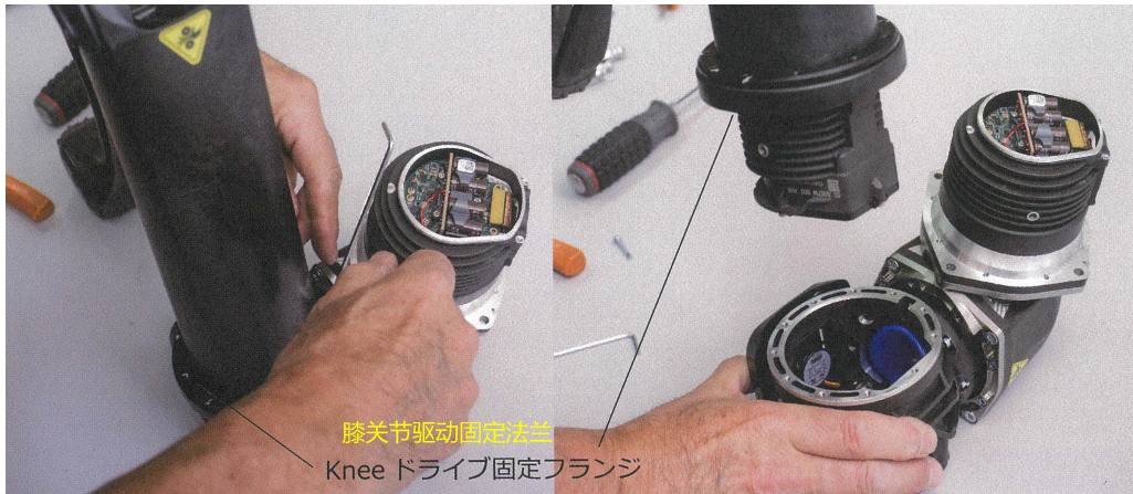
图 5.5: 卸下膝关节驱动装置的法兰 需要拆下固定膝部驱动单元的法兰的12个M3螺栓。(照片:加藤康)
