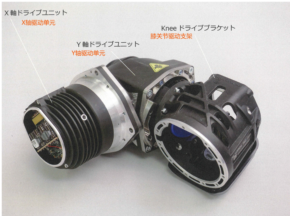
图 5.42: X轴驱动和Y轴驱动 旋转系统通过组合 X 轴和 Y 轴来确定膝盖输出的方向。(照片:加藤康)
