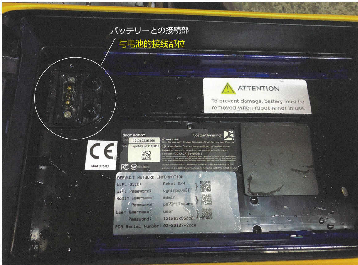
图 4.35: 直接浸没后的电池仓 电池仓本身没有密封功能，很多水滴附着在接线端子周围。(照片:Nikkei Cross Tech)
