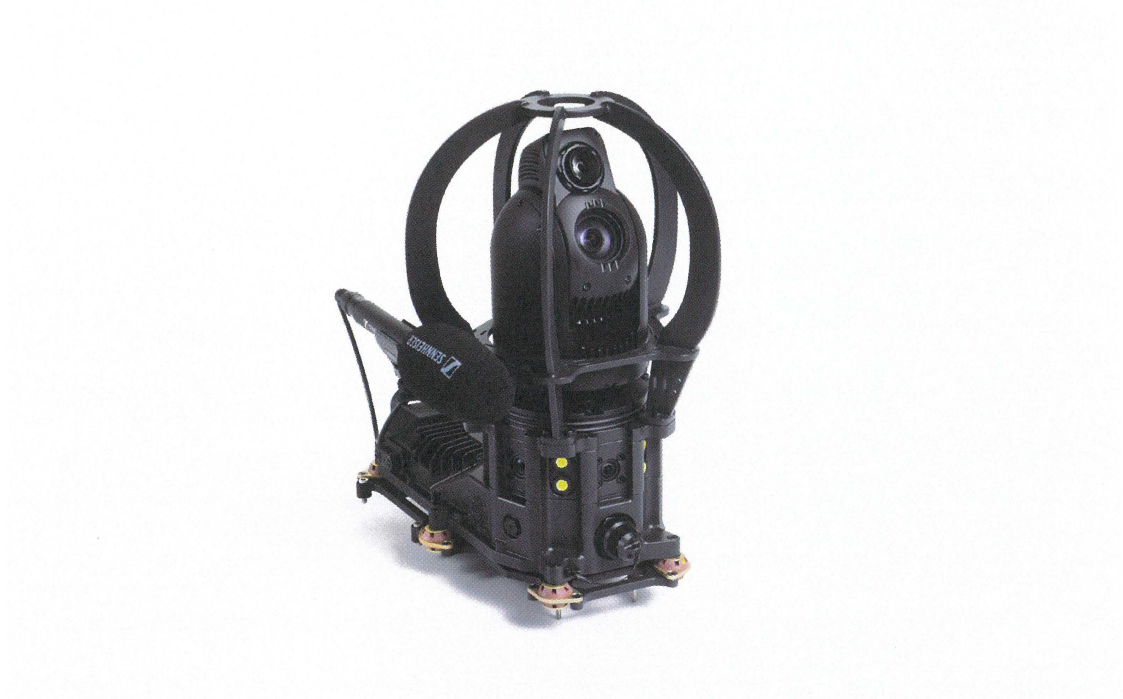
图 1.16: THERMAL外设的外观 除INSPECTION外还安装了红外摄像头。(照片:Boston Dynamics)
