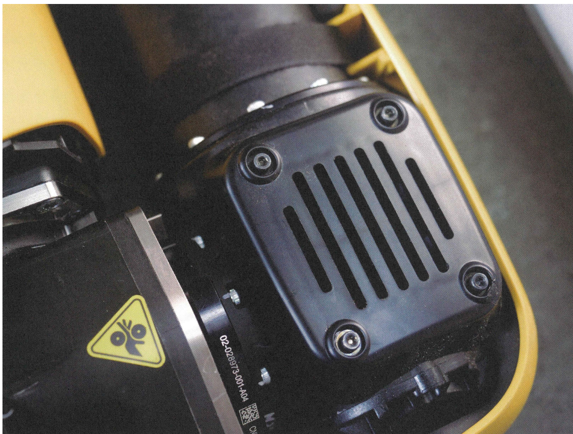
图 4.11: 膝关节驱动电机的冷却部分 提供专用风扇来冷却电机和逆变器。(照片:加藤康)
