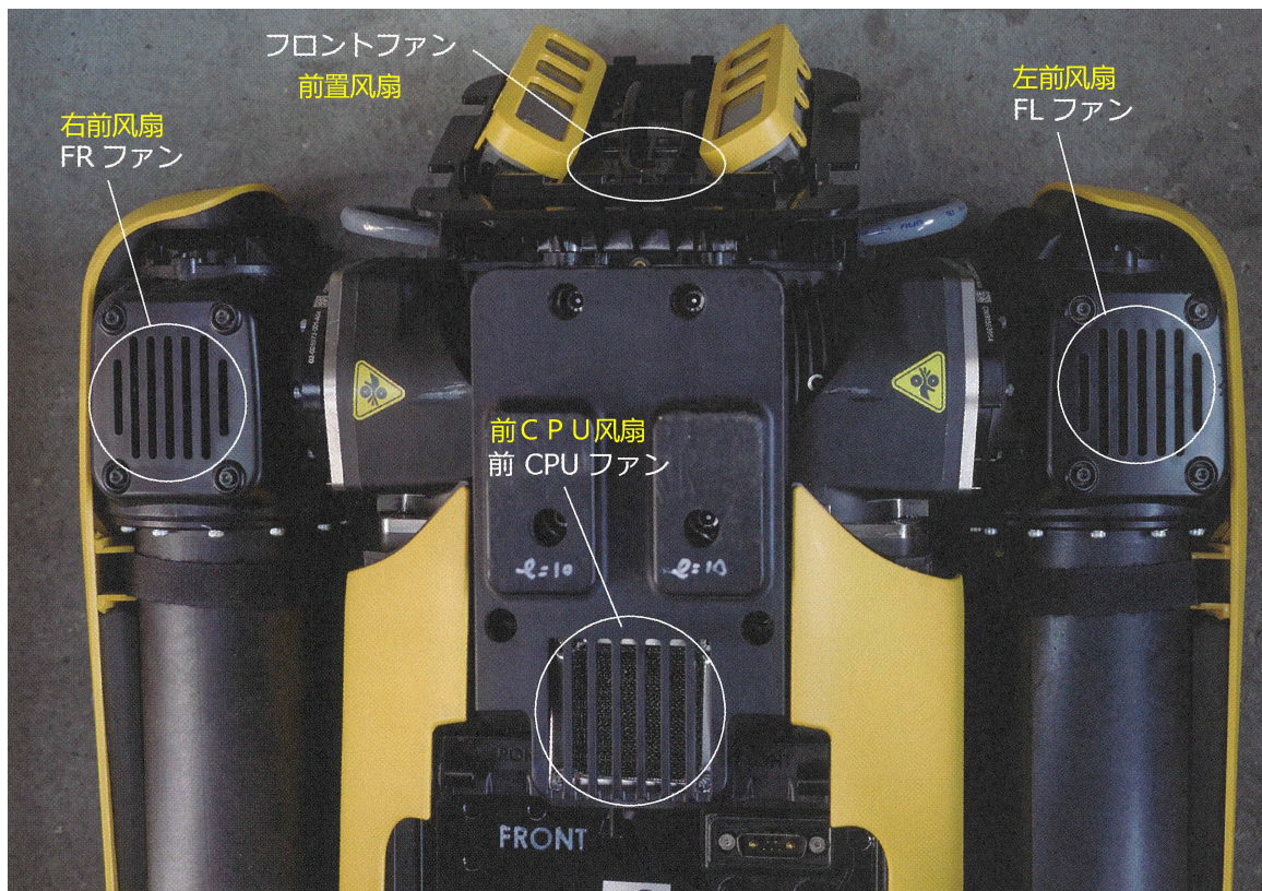
图 6.22: 冷却风扇的放置 它有4个风扇用于前部 (Y 轴)、左右腿 (膝部) 和前CPU。后部也是如此，一共8个风扇，展示了机器人发热的大小。 (照片:加藤 康)
