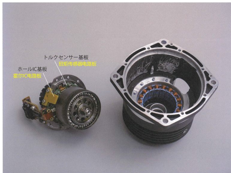
图 6.49: 扭矩传感器电路板和霍尔IC电路板 照片是Y轴电机驱动, 但X轴也一样。(照片:加藤 康)
