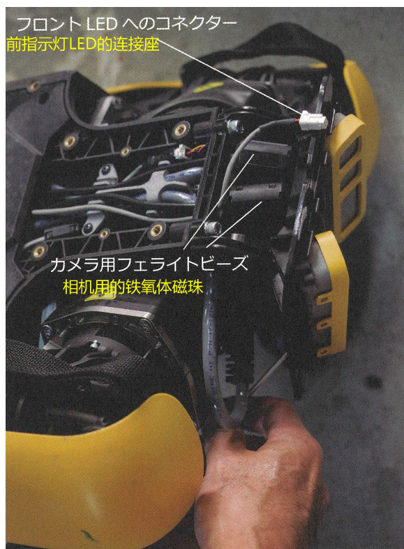
图 4.14: 前机架拆解 要卸下前机架，必须先卸下摄像头模块，然后才能进行下一个拆解过程。扳手不适合笔直插入。(照片:加藤康)
