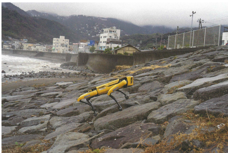
图 3.10: 爬岩石的Spot 如果抓地力有效，Spot可以爬上岩石区，但如果岩石区又湿又滑，它就会摔倒。此外，如果它的腿夹在岩石和岩石之间，则将无法移动并停止。(照片:Nikkei Cross Tech)
