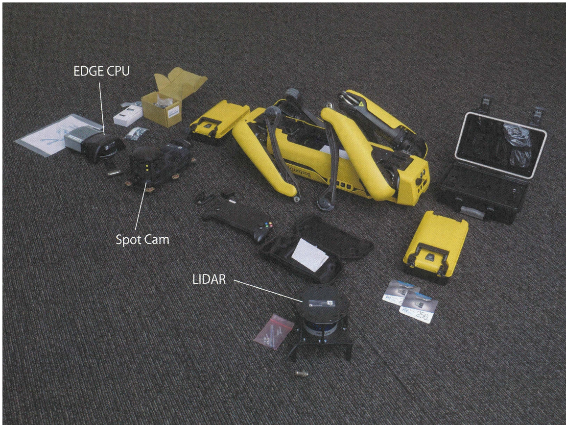
图 7.1: 购买的Payload 购买了Spot Cam和EAP(包括LIDAR和EDGE CPU)。(照片:加藤康)
