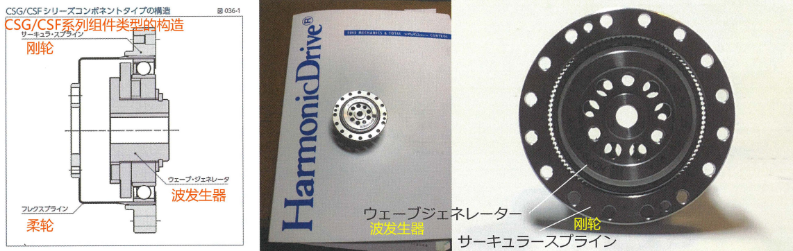
图 5.37: 谐波驱动系统的原理 当椭圆波发生器旋转啮合位置时，通过每旋转一圈的刚轮和柔轮之间的齿数差来传动刚轮。从最右侧的照片中，可以看到只有顶部和底部接合。(左图来自Harmonic Drive Catalog，照片：松田篤志)
