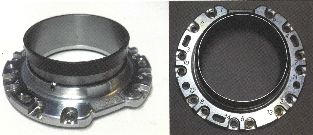
图 5.39: 编码器凸台 带有磁铁的铁圆筒被压配合到铸铝部件中，通过霍尔IC读取旋转位置。螺丝的拧紧顺序也有刻印，是一个很漂亮的部分，设计的相当精致。(照片:松田篤志)
