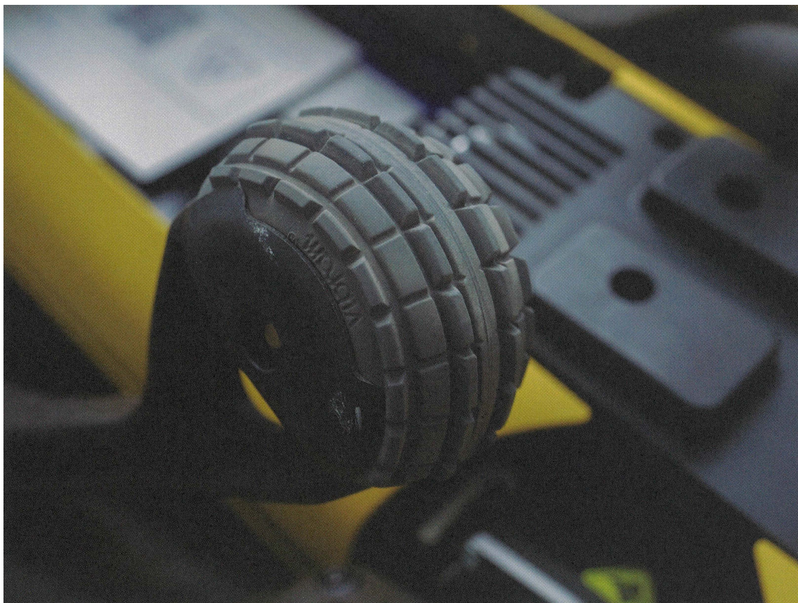
图 3.12: Spot的腿尖 意大利Vibram制造。已经安好带凹槽的橡胶，但非常容易打滑。(照片:加藤康)
