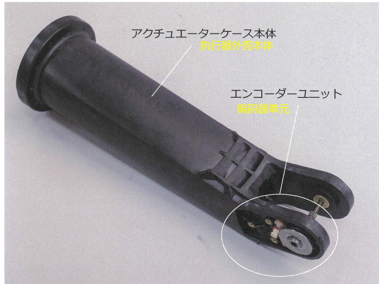
图 5.20: 膝关节驱动单元线性执行器外壳 对应于手臂的骨架。外骨骼包含肌肉(执行器)。结构与蟹腿相同。测量轴角度的编码器位于尖端。(照片:加藤康)
