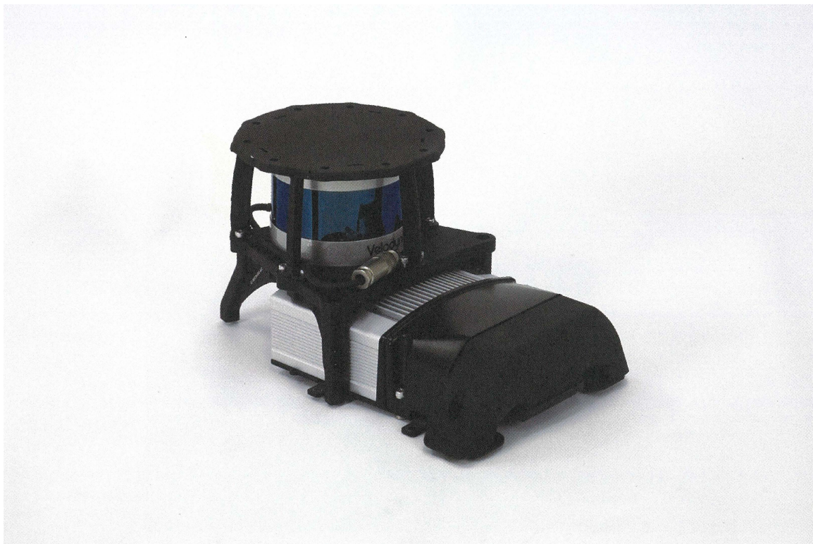
图 1.19: LIDAR外设的外观 在大型仓库和户外空间自主行走所必需的。(照片:Boston Dynamics)
