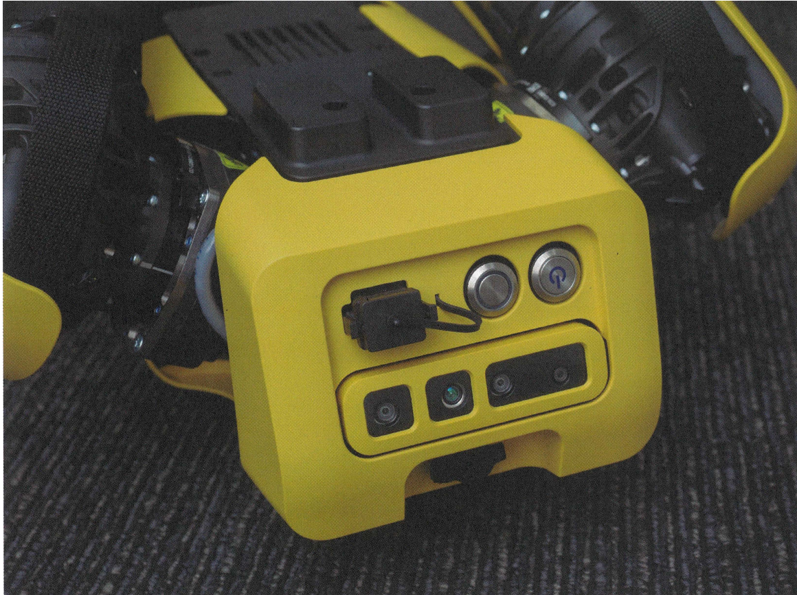
图 6.4: 后机架上的以太网端口 取下左上方的机盖会露出RJ45端口。可以直接连接到PC并执行设置和命令操作等任务。(照片:加藤康)
