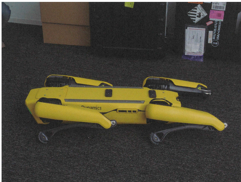
图 3.2: 启动前的姿势 启动前的参考状态。说明书上说2个人拎着4个角可以看到的提手带，从这个状态打开电源开机。(照片:加藤康)
