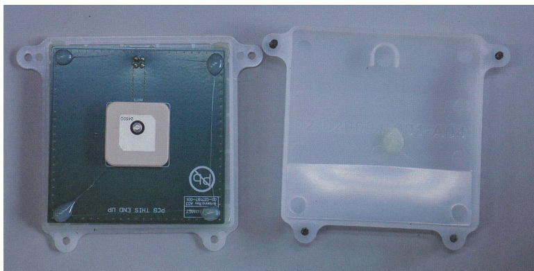
图 6.13: WiFi天线 安装天线的电路板安装在树脂壳中。在这种情况下没有考虑防水或防尘。(照片:加藤 康)
