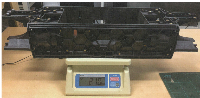
图 4.22: 中心机架重量测量 重量是2.1 kg，相对于它的大小来说感觉很轻。(照片:松田篤志)
