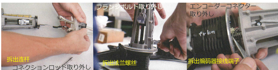
图 5.9: 线性执行器的拆卸 可以通过拆下固定电机单元和线性执行器外壳的4个螺丝，然后断开编码器连接器将其分开。(照片:加藤康)
