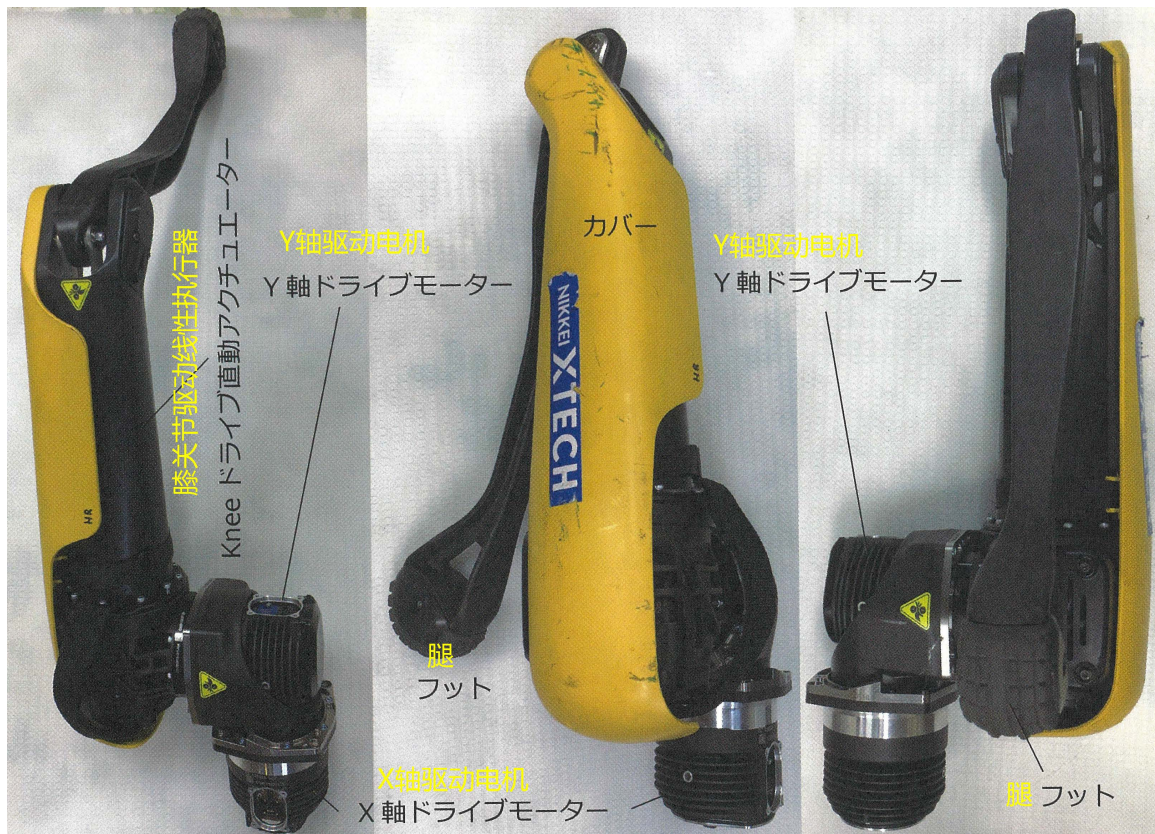
图 4.27: 脚部整体状况 四足步行机器人Spot最具特色的是腿部驱动组件。充分利用这四条腿，可以在各种地形上行走。(照片:加藤康)
