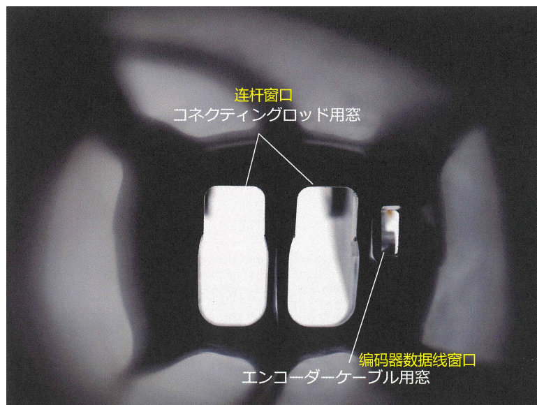
图 5.21: 膝关节驱动单元线性执行器外壳的内侧 有让线性执行器的两个连杆杆头通过用的窗口和右边有让编码器线缆通过用的窗口。(照片:加藤康)
