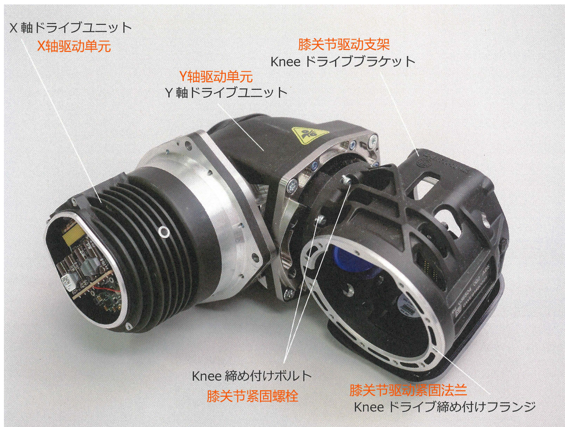
图 5.24: 膝关节驱动支架 对应于肩关节或髋关节的2轴旋转单元。线性执行器机构连接到法兰的端面。(照片:加藤康)
