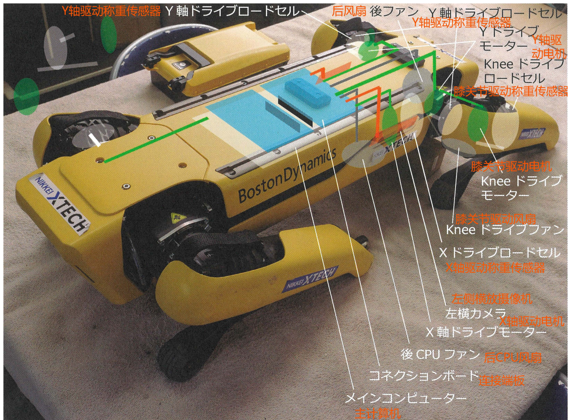
图 6.2: Spot的后半部分接线图 后连接端板接线示意图。(图片:松田篤志在加藤康的照片中添加文字)
