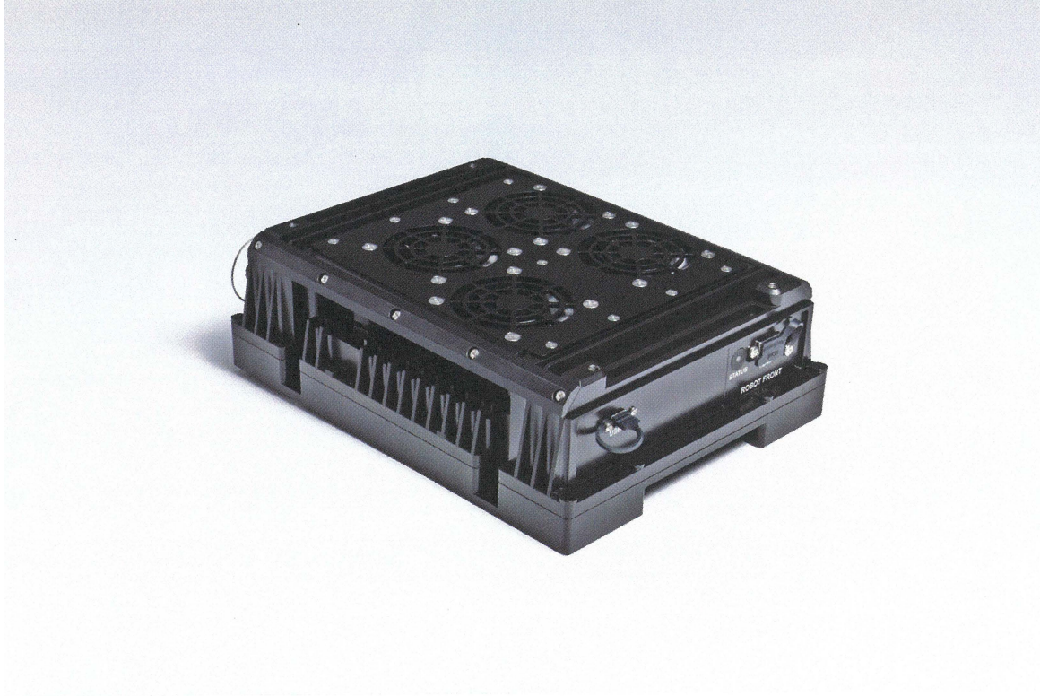
图 1.18: EDGE GPU外设的外观 可以执行需要大量计算（例如机器学习）的专用应用程序。(照片:Boston Dynamics)
