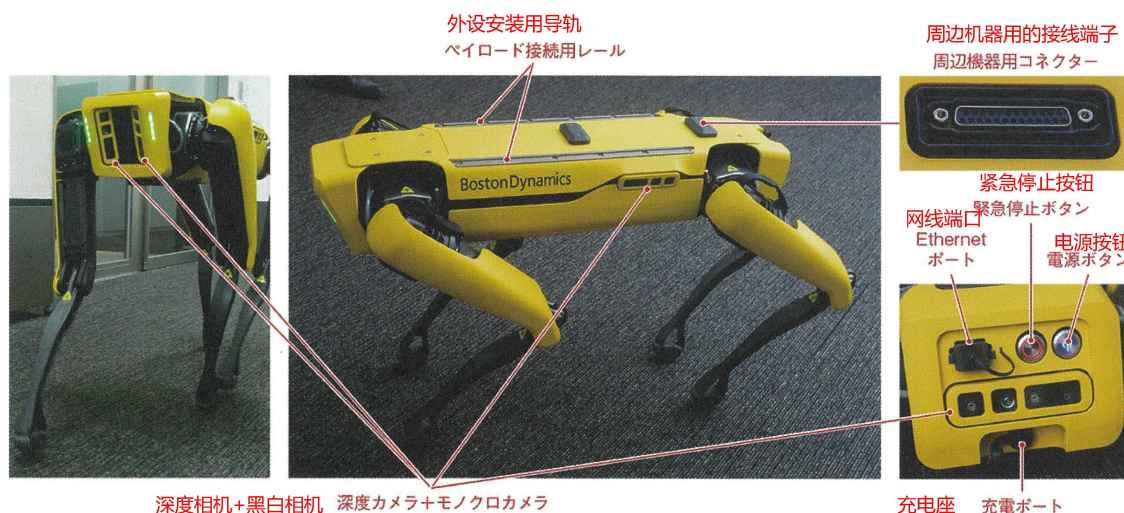
图 1.11: Spot的外部扩展功能 背面有导轨，可以安装Payload。此外，还有两个接线端子用于Payload和主机之间的电气连接。(照片:加藤康)
