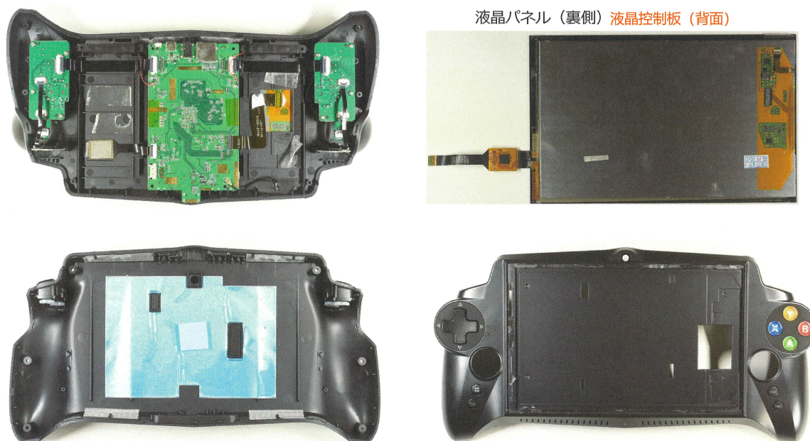
图 6.59: 遥控器的内部 它结构简单，主要由主控电路板、液晶面板和电池组成。(照片：Fomalhaut Techno Solutions)
