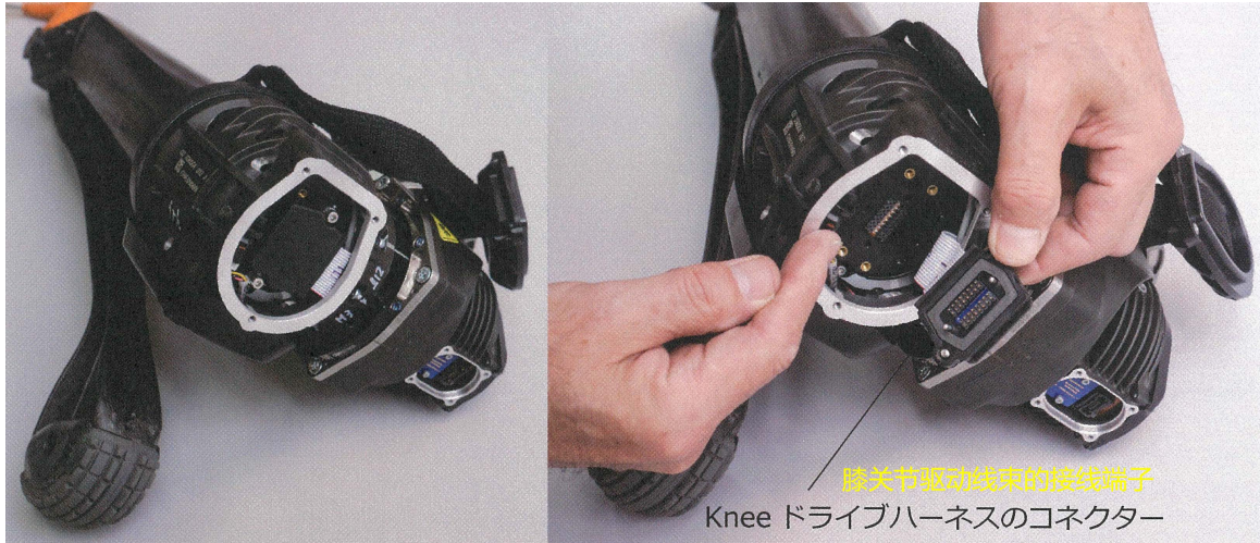
图 5.4: 膝关节驱动线束 驱动膝关节驱动系统前端的线性执行器的线束通过摆动的Y轴进行连接。接线端子和触点使用安装在电路板上的产品。膝关节驱动线束延伸到右侧照片下方可见的蓝色电路板。(照片:加藤康)
