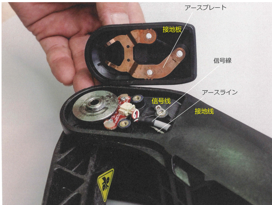
图 5.22: 膝关节驱动编码器结构 与膝盖角度相连的磁码盘的角度由霍尔IC测量。盖子那侧的铜板是将带在腿上的静电释放到车身那一侧的接地。黄色标签提醒人们注意夹手指。(照片:加藤康)
