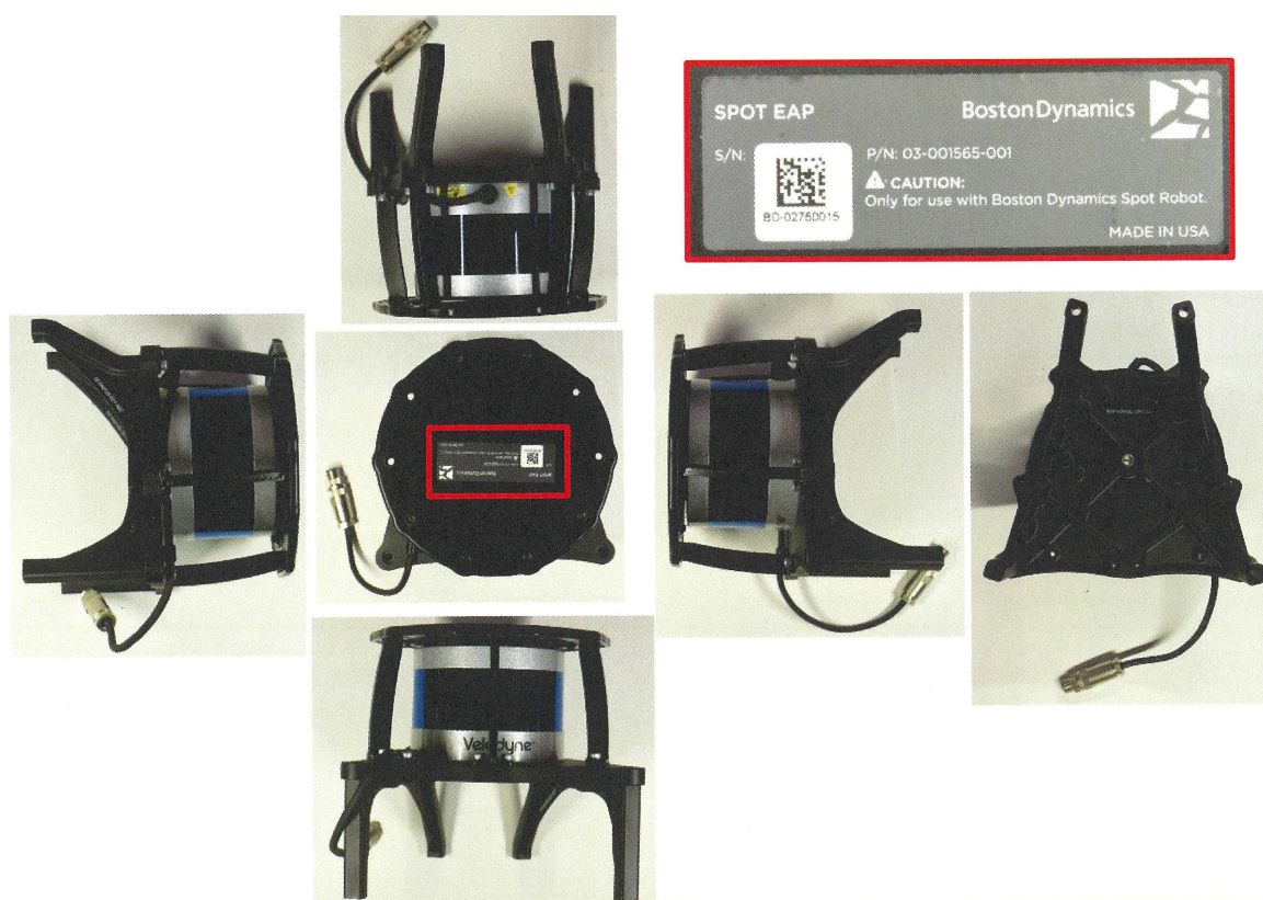
图 7.21: Spot用的LIDAR的外观 主体是Velodyne的“VLP-16”激光雷达。(照片: Fomalhaut Techno Solutions)
