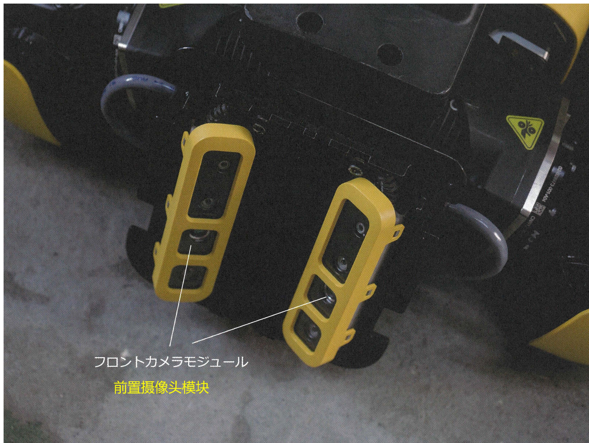
图 4.13: 前机架 取下前盖从下面看。可以看到两组前置摄像头模组向内倾斜。似乎是故意将摄像头的视角重叠起来，用作立体摄像头。(照片:加藤康)
