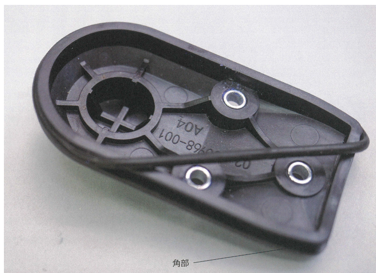
图 4.32: 编码器盖 编码器盖。用O型圈密封的，但不能指望与棱角部分紧密接触，所以很容易产生间隙。(照片:Nikkei Cross Tech)
