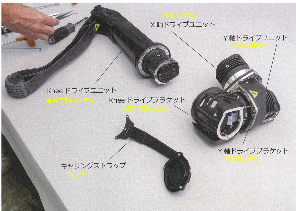
图 5.6: 分离膝关节驱动单元 X轴和Y轴(旋转轴)驱动单元和Knee驱动(线性运动)分离。(照片:加藤康)
