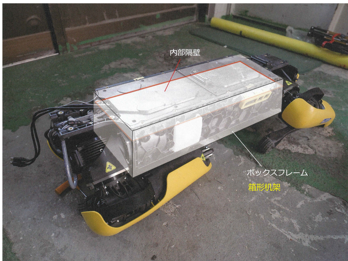
图 4.26: 箱形机架结构 Spot的“主干”对应的结构是一个箱形机架。下部有一个大开口用于电池和主计算机，因此只有内部隔板的上部作为扭矩管有效。(照片:加藤康)
