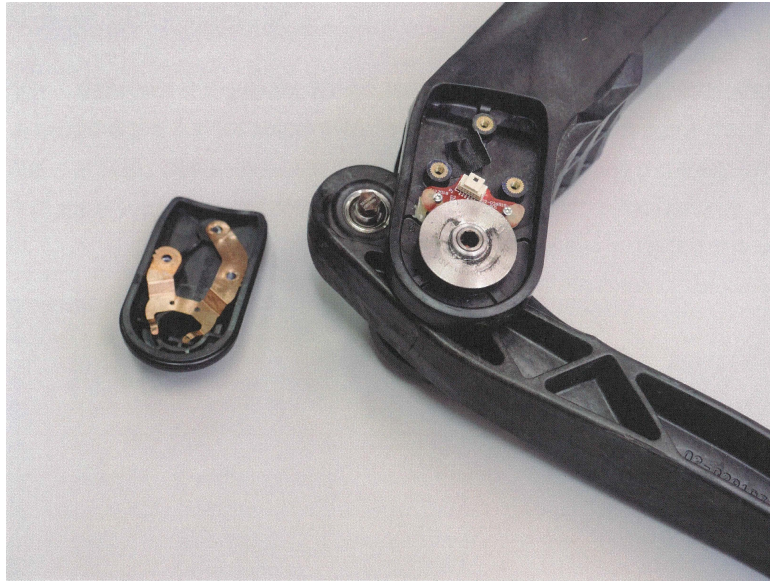
图 6.48: 编码器电路板 在金属盘下面可以看到的电路板是编码器电路板。(照片:加藤 康)
