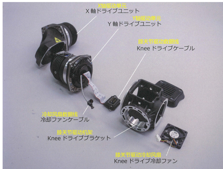
图 5.26: X轴和Y轴驱动构成 为实现复杂的腿部运动，各轴布局合理紧凑。(照片:加藤康)
