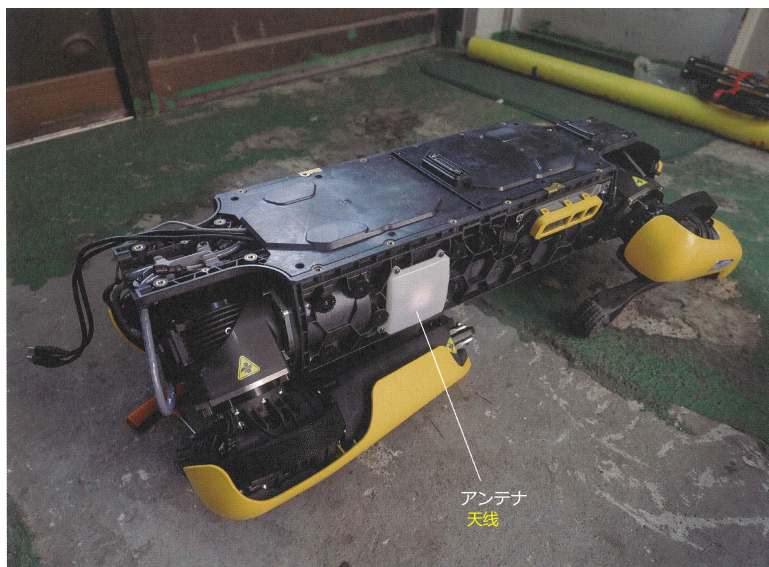
图 6.12: 天线安装位置 天线安装在Spot中心机架的两侧。连接线缆穿过中心机架上的孔延伸到中心机架下侧的电池座内部。(照片:加藤 康)
