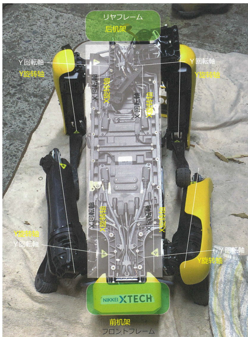
图 4.12: 机架结构概要 腿连接到了容纳主计算机等的箱形结构的四个角上。(照片:加藤康)
