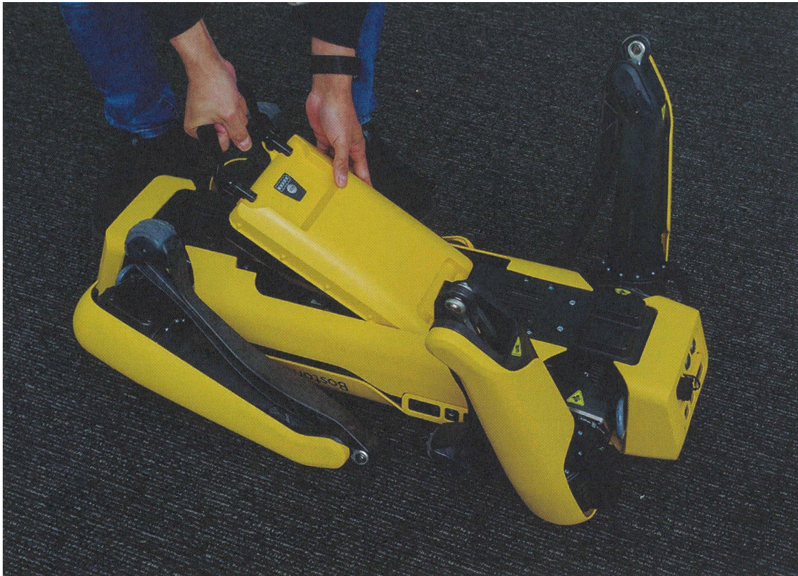
图 1.6: 电池安装在Spot中的位置 除可以通过使用数据线直接将电池盒和充电器连接起来充电外，还可以通过将充电器数据线连接到Spot后面的插座来充电。(照片:加藤康)
