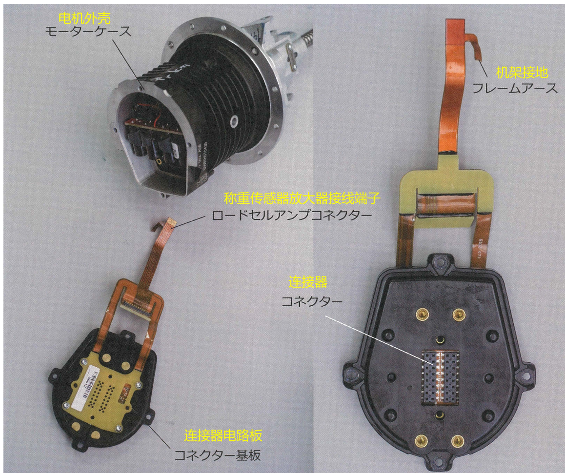
图 5.12: 膝关节驱动板线缆 它分为电机驱动器和称重传感器放大器2个系统。(照片:加藤康)
