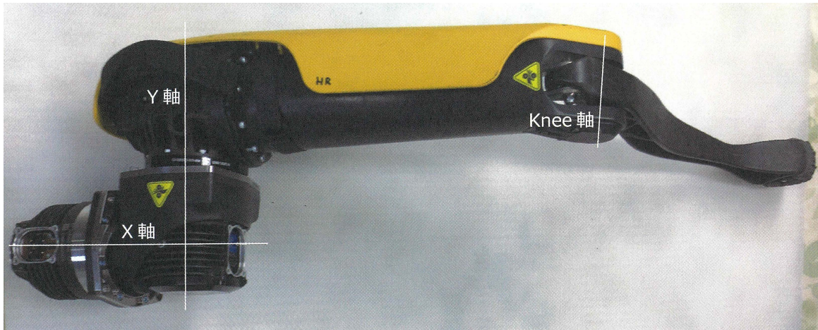
图 3.1: 腿驱动组件 一条腿具有“X轴”、“Y轴”和“膝部”3个自由度的旋转关节。“X轴”和“Y轴”由电机直接旋转驱动，“膝部”与实际肌肉相同，由有推拉伸杆的线性执行器驱动。(照片:加藤康)
