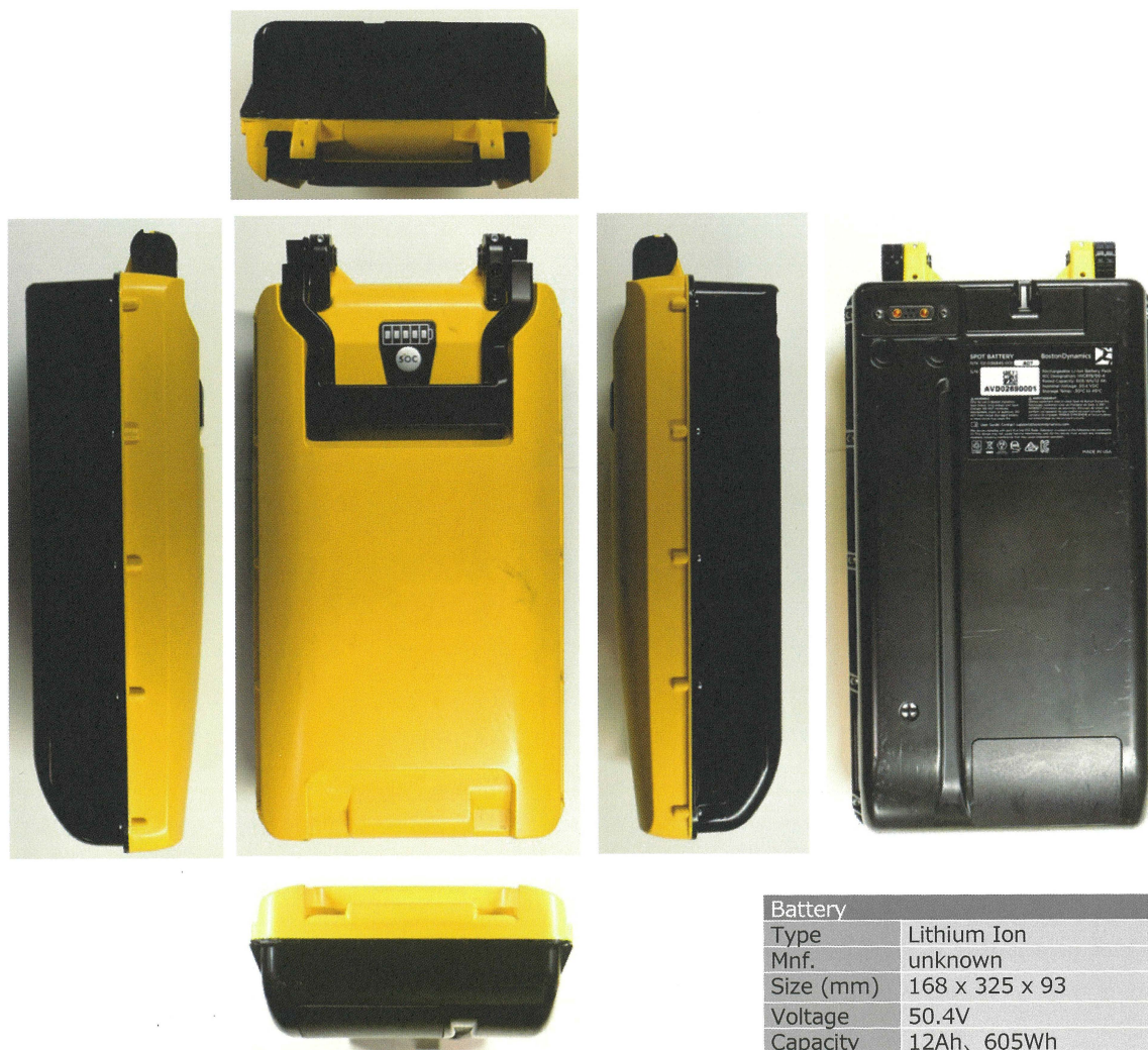
图 6.54: 电池组的外观连接到Spot的腹部。电池组的尺寸为168 mm × 325 mm × 93 mm。电压为50.4 V。容量为605 Wh。(照片: Fomalhaut Techno Solutions)
