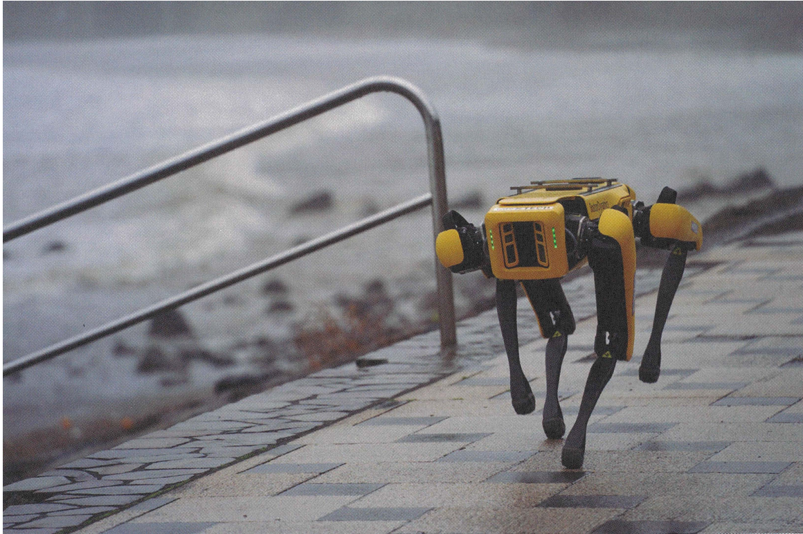
图 3.4: 步行的Spot 前腿和左后腿抬起，然后左前腿和右后腿抬起，依此类推，斜腿交替抬起移动。(照片: Nikkei Cross Tech)
