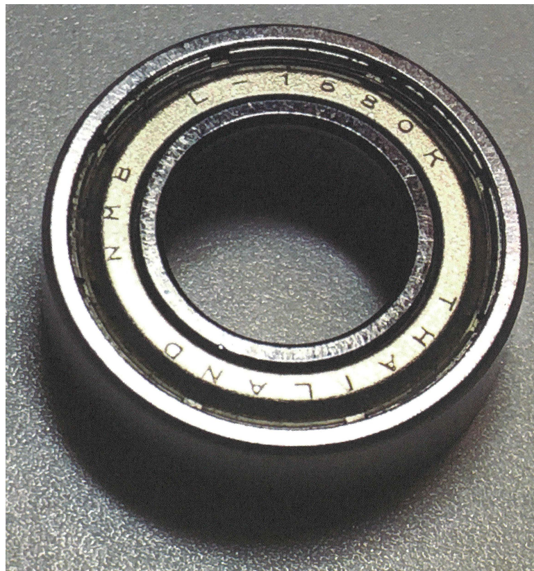
图 5.33: 电机轴的轴承 使用的是美蓓亚三美的微型轴承。制造国是泰国。(照片:松田篤志)
