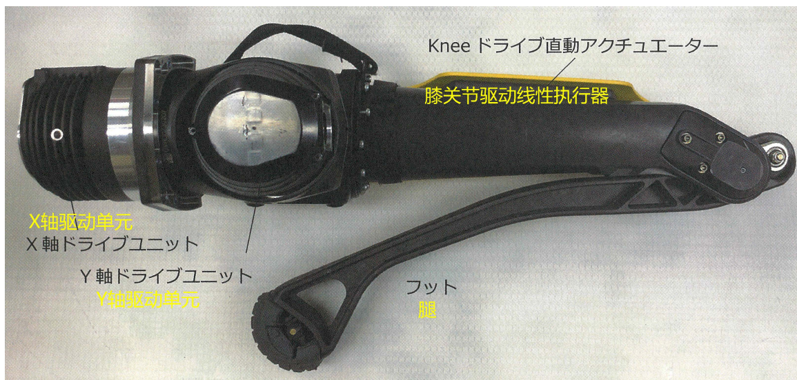
图 4.28: 腿驱动组件的机构 实现四足行走的腿是基于2轴旋转和1轴线性运动。因此，每条腿有3个驱动电机。虽然旋转驱动和线性驱动的减速机不同，但3种电机的设计都是一样的。(写真:加藤康)
