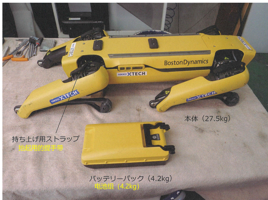
图 4.2: 拆卸前主体和取出电池的状态 体型约为一抱的大小重量31.7 kg(含4.2 kg电池)。电源电压为58.8 V。为了拆解工作的安全, 需要注意这个重量和直流高压。此外, 在搬运过程中, 有必要提着在四个“肩关节”和“髋关节”处设置的提手带, 以免手指被关节夹住。(照片:加藤康)
