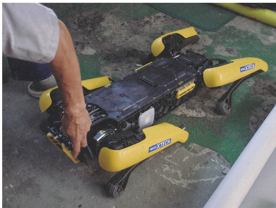
图 4.3: 拆下主体机盖的状态 机盖用魔术贴等固定, 便于拆卸。(照片:加藤康)
