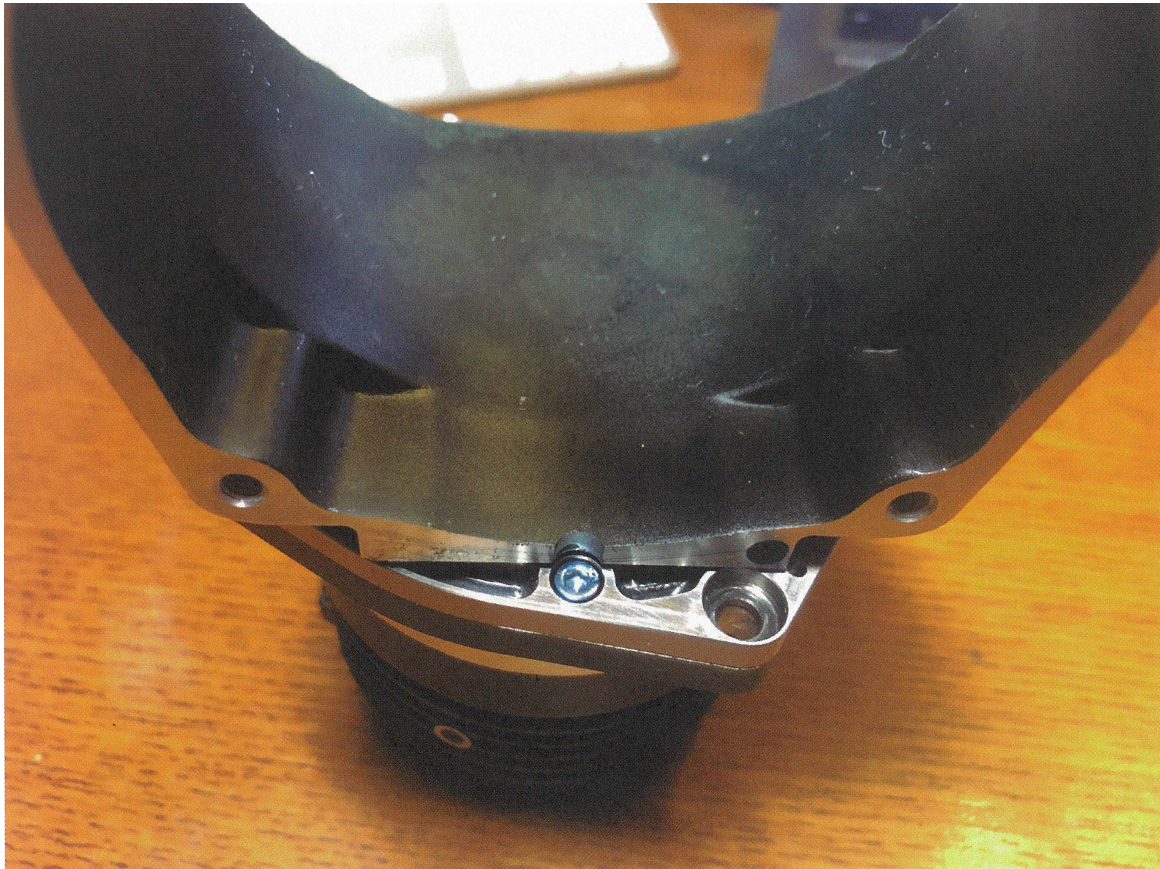
图 5.43: 螺丝的拧出缺口 提供 X 轴以避免用于固定 Y 轴电机法兰的大支架。(照片:松田篤志)
