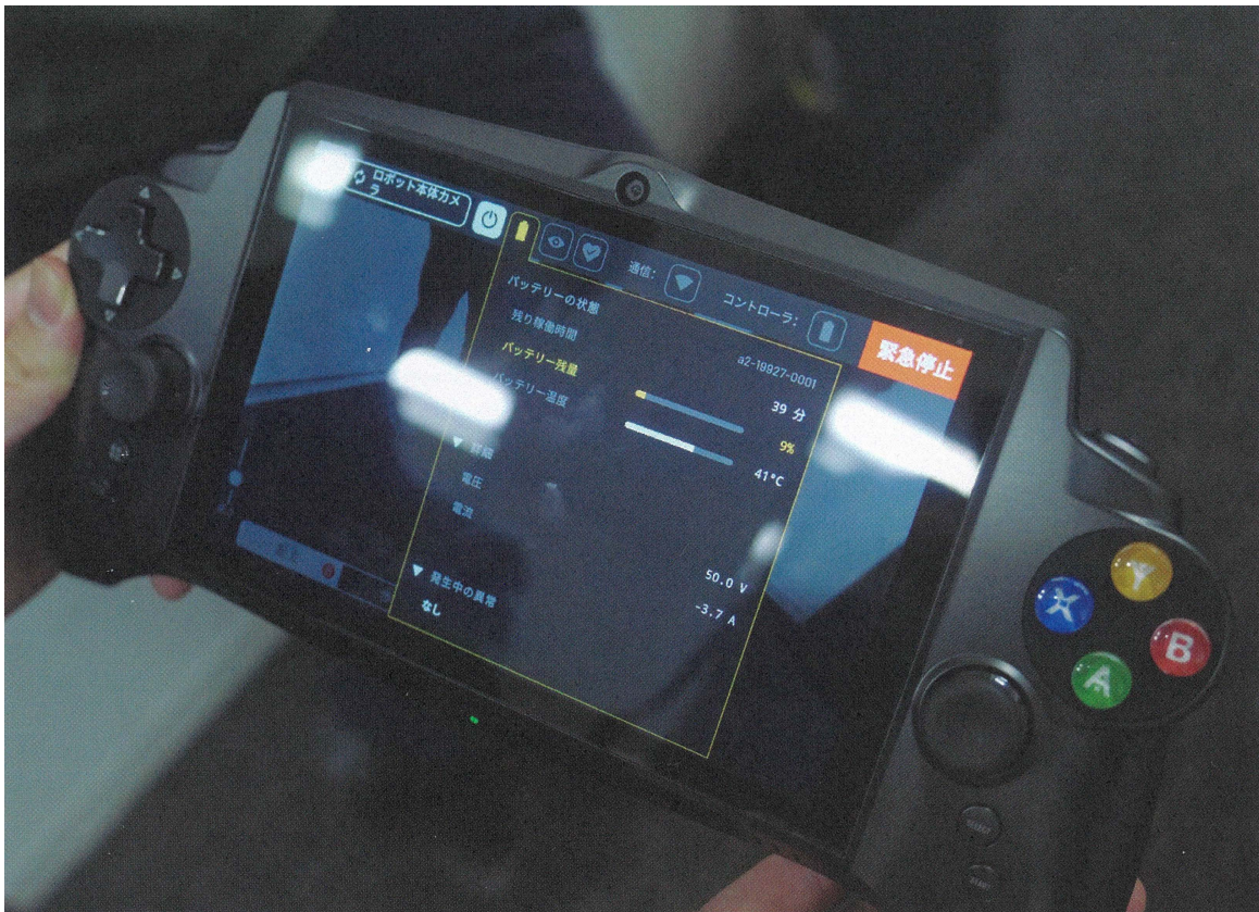
图 1.8: 使用Spot遥控器检查电池电量 可以从遥控器确认Spot的设置、错误信息等。(照片:加藤康)
