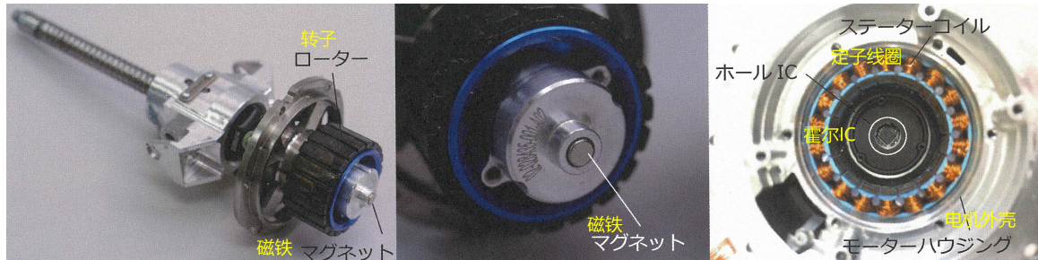
图 5.16: 膝关节驱动电机转子磁铁和霍尔IC 电机转子端磁铁与电机驱动板中央的霍尔IC相对，测量转子的旋转相位。(照片:加藤康)
