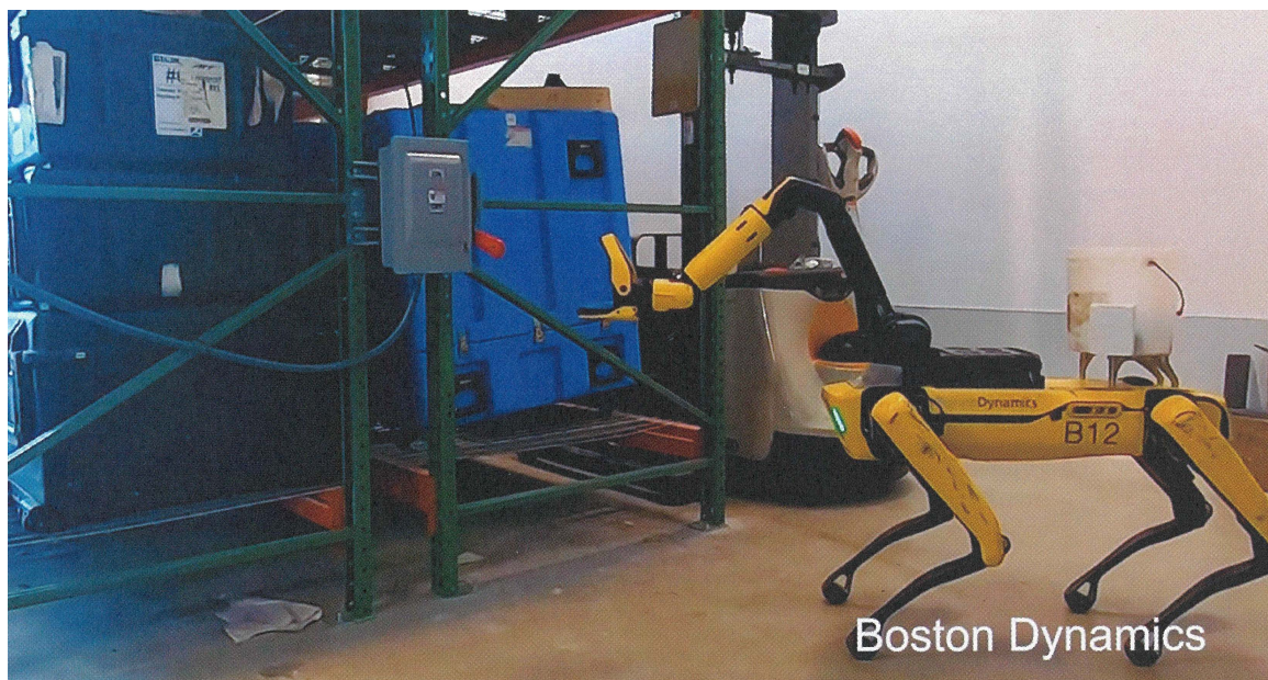
图 1.20: 可以操作把手的Spot Arm 可以操作手柄和把手，打开门并通过。此外，也可以把东西组装起来放在背上的篮子里，或者拿着粉笔在路上画字母图画。(图片:Boston Dynamics的YouTube视频截图)
