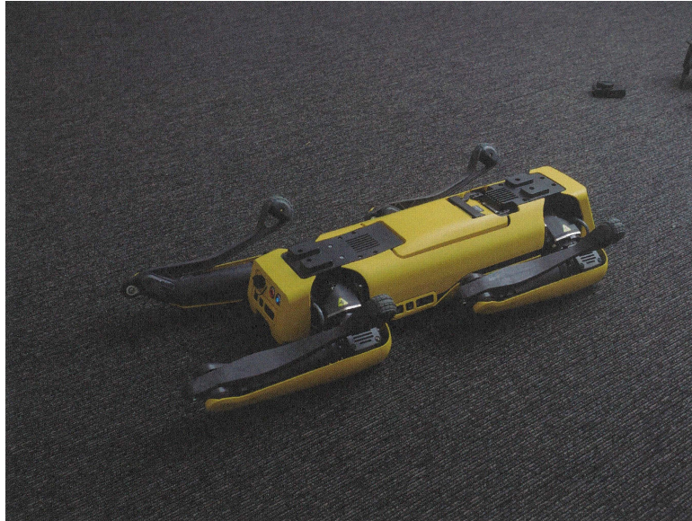
图 3.5: 从跌倒中恢复(1) 完全翻转时的初始状态。(照片:加藤康)
