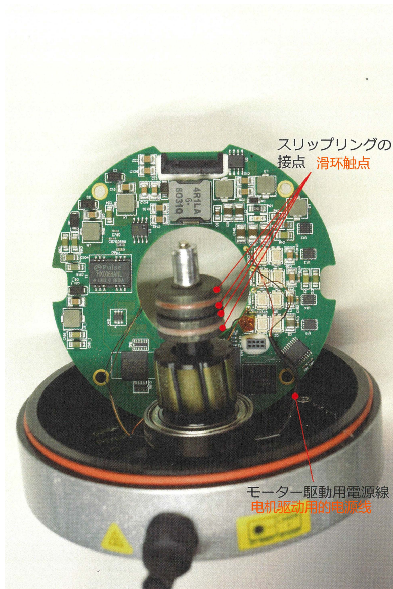
图 7.25: 滑环 在轴的顶部可以看到滑环触点。信号处理电路板和电源/接口电路板通过此连接。(照片: Fomalhaut Techno Solutions)
