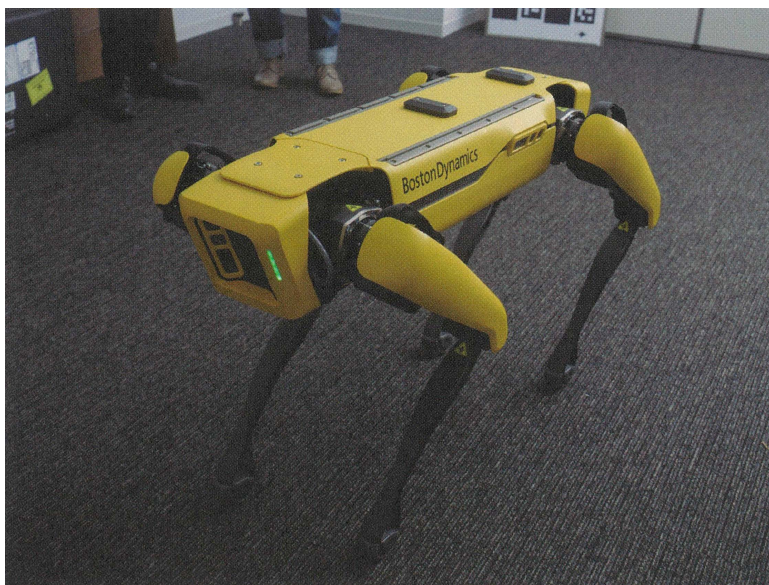
图 3.3: 站立姿势 打开电源，系统待机后发送站立命令，Spot将在此位置站起来待命。(图:加藤康)
