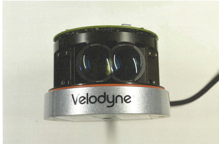
图 7.23: 所有电路板都旋转 所有电路板都通过连接器连接，并具有同时旋转的结构。顶部可以看到信号处理电路板。(照片: Fomalhaut Techno Solutions)
