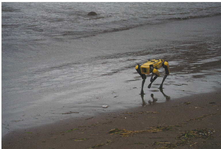
图 3.9: 沿着海滩走的Spot 在沙地里腿稍微下沉的话还是可以稳定地行走。(照片:Nikkei Cross Tech)
