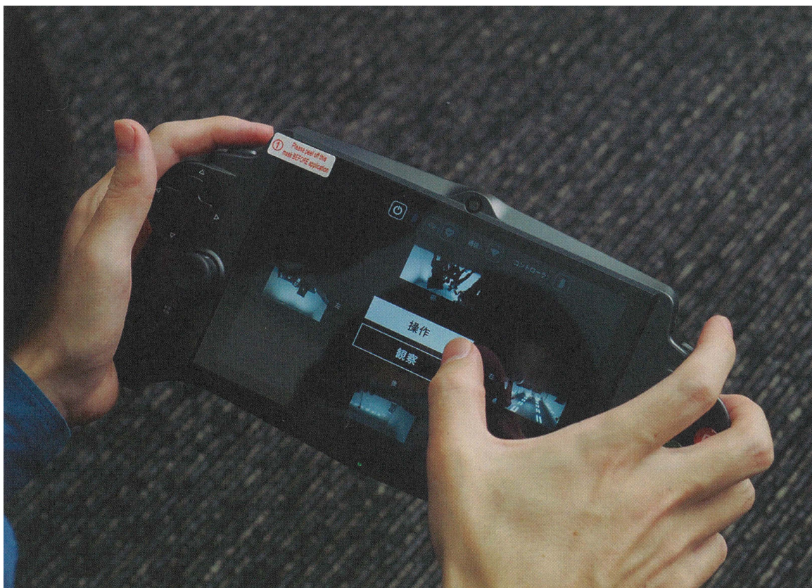
图 1.7: Spot遥控器 使用两个操纵杆进行操作。(照片:加藤康)
