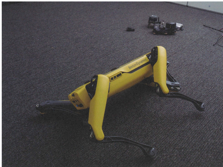
图 3.8: 从跌倒中恢复(4) 当身体旋转后它返回到俯卧状态。(照片:加藤康)
