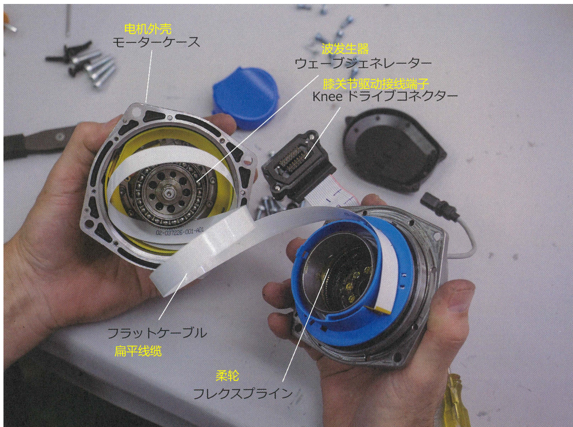
图 5.28: Y轴驱动内部结构 在机器人的驱动机构中安装谐波驱动器是很常见的。扁平线缆以螺旋圈的形状缠绕在其周围，可以允许角位移。这些是汽车转向等常用的机构。(照片:加藤康)
